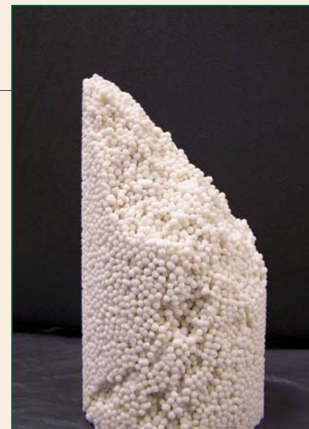
Figuur 2: Voorbeeld van een echte vrije kolom test, met A) de opgebouwde kolom, en B) de bezweken kolom.
